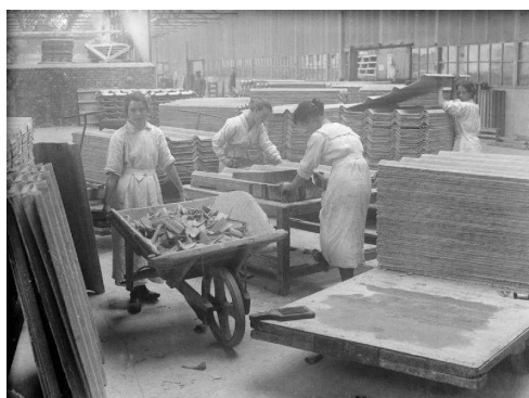
Fabrication d'éléments de toiture en fibrociment Image Wikipedia
